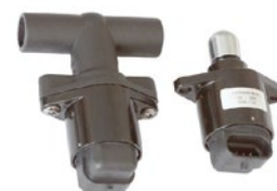
35PM42Z 57мм 0.0417мм/крок 20 Н; 12 В; 0,23 А; 12 мм Для регулювання холостого ходу двигунів внутрішнього згоряння
