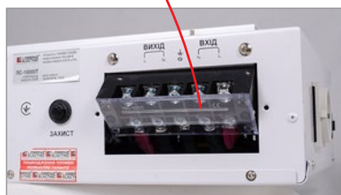
Клемна колодка (захисна кришка знята)
