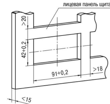
**Рис. А.3. Прибор щитового крепления Щ2**
