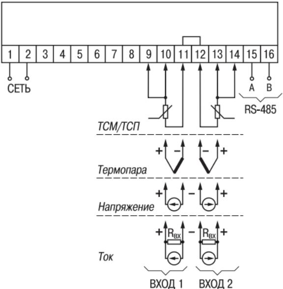
**Рис. В.1. Общая схема подключения TPM200**
