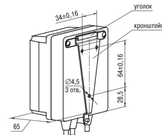
**Рис. А.1. Прибор настенного крепления Н**
